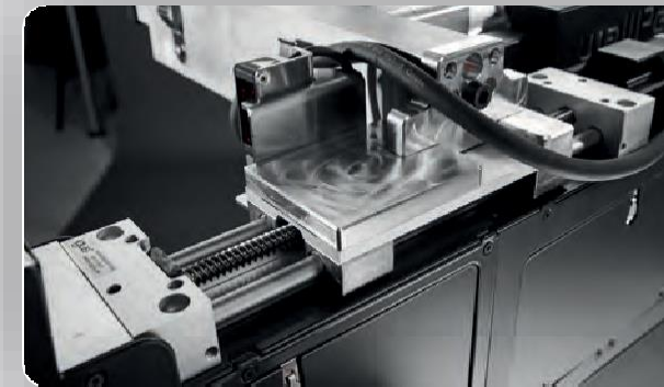
Hochpräzise Führung des Druckkopfes zur Wand hin. Gleicht Wandunebenheiten von bis zu 10 cm aus.
